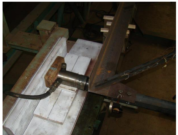
Рис. 11. Узел установки гидравлического домкрата ДГ-10
