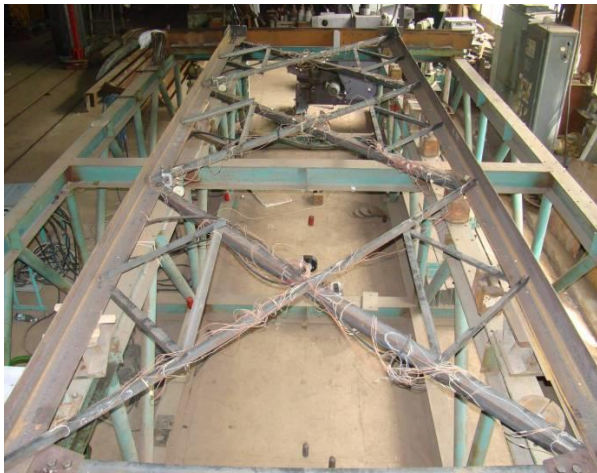
Рис. 8. Общий вид испытуемой фермы (решетка L63x5)
