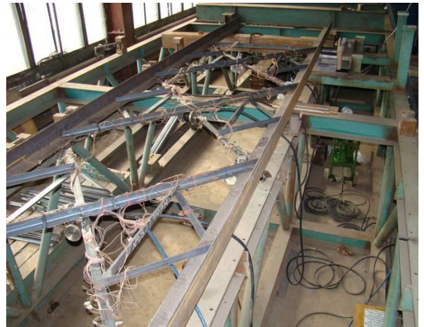
Рис. 9. Общий вид испытуемой фермы (решетка L45x4)
